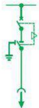
Unidad de protección del transformador
